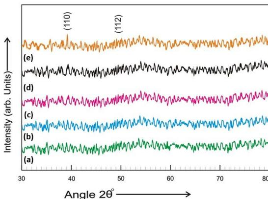
**Fig. 1 X-ray diffraction patterns of CdTe nanoparticles refluxed at (a) 15 min (b) 30 min (c) 45 min (d) 60 min (e) 120 min**
