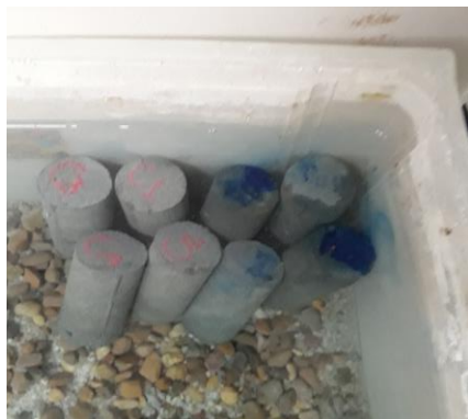
Figura 9: Cura dos corpos de prova submersos no tanque com água. Fonte: Autor, 2018.
