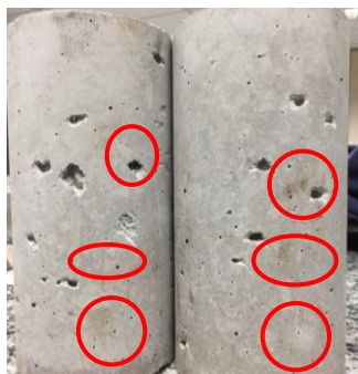
Figura 12: Corpos de prova com círculos vermelhos evidenciando a manifestação da bactéria bacillussubtilis, em 28 dias de observação. Fonte: Autor, 2018.
