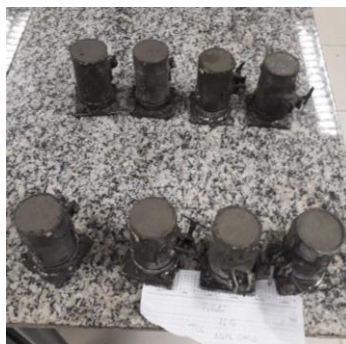
Figura 8: Moldagem de seis corpos de prova da argamassa industrializada, homogeneizada com a água da bactéria BS. Fonte: Autor, 2018.
