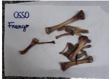
Figura 3: Resíduo (osso de frango) para determinação da composição química. Fonte: Autor, 2018.
