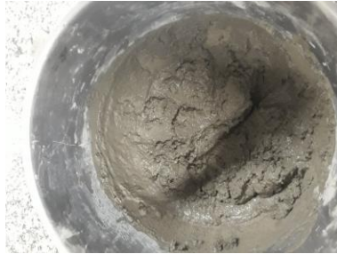
Figura 7: Argamassa industrializada homogeneizada na argamassadeira. Fonte: Autor, 2018.
