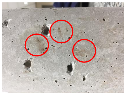
Figura 11: Corpo de prova horizontal com círculos vermelhos evidenciando a manifestação da bactéria bacillussubtilis, em 7 dias de observação. Fonte: Autor, 2018.
