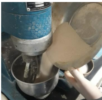
Figura 6: Argamassa industrializada, pesada, sendo inserida no equipamento (argamassadeira) para a mistura. Fonte: Autor, 2018.
