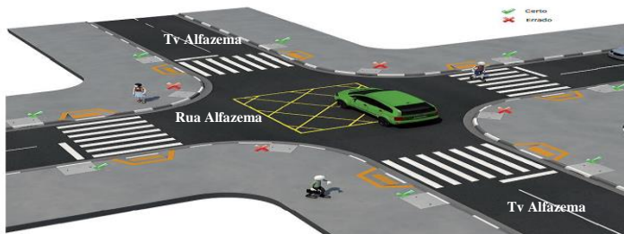
Figura 5. Esquema de locação das bocas de lobo da Rua Alfazema antes e depois da locação. Fonte: Autor Próprio, 2018.
