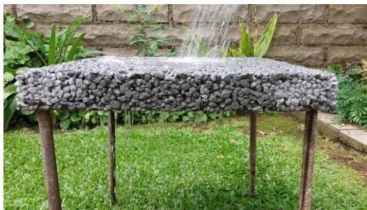
Figura 2 - Caracterização da drenagem no concreto permeável, Viridiana Spinelli, 2017.
