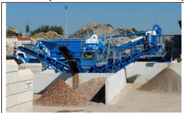
Figura 1: Usina fixa de reaproveitamento de resíduos de construção civil
