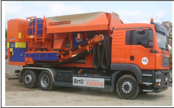
Figura 2: Usina móvel de reaproveitamento de resíduos de construção civil
