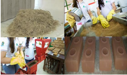
Figura 6: Concreto Reciclado de resíduo de fibra orgânica
