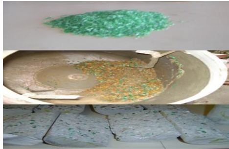
Figura 5: Concreto Reciclado de resíduo de plástico polietileno tereftalato (PET)
