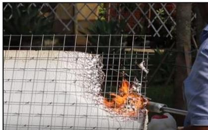
**Figura 4: Teste de incêndio de EPS. Fonte: Adaptados pelo autor.**
