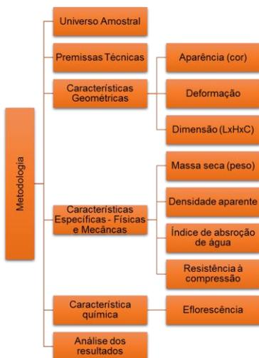
**Figura 6: Fluxograma da realização das atividades para caracterizar os tijolos cerâmicos das olarias selecionadas. Fonte: Autor, 2018.**
