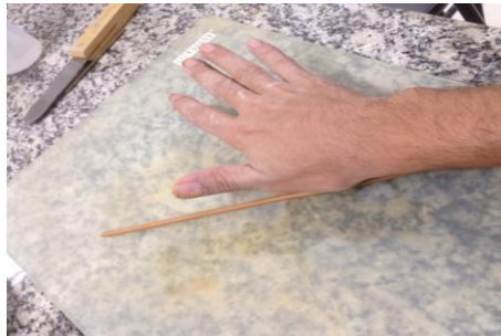
Figura 8: Realização do ensaio de LP em cima da placa esmerilhada.
