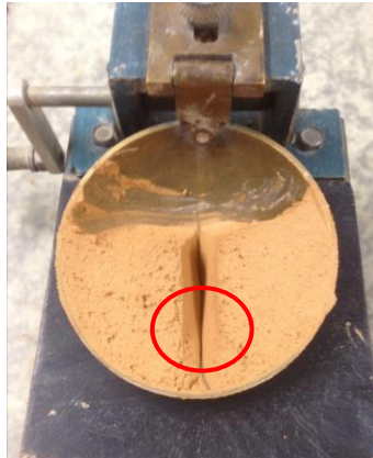
Figura 6: Aparelho de Casagrande com a amostra sobre posta na concha, a arranhura feita e a identificação do ponto onde as bordas se encontram.
