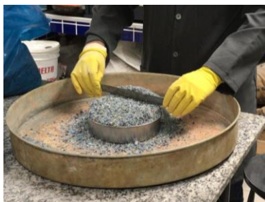
Figura 3: Determinação da massa unitária dos polímeros termoplásticos.
