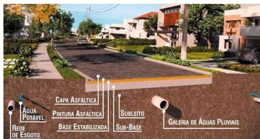
Figure 3 – Projeto de Drenagem Urbana - Fonte: RAMBLA PROJETOS DE INFRAESTRUTURA, 2018.
