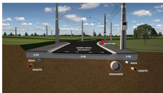
Figure 4 – Projeto de Drenagem Urbana - Fonte: RAMBLA PROJETOS DE INFRAESTRUTURA, 2018.
