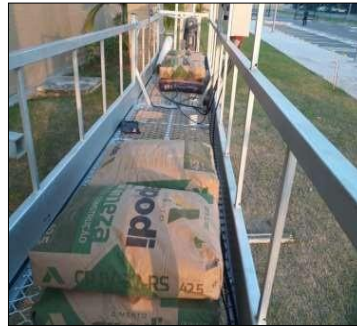
Figura 18: Teste de carga
