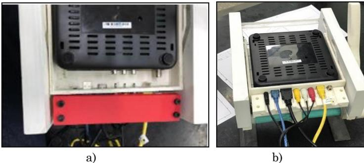
**Figura 5: Vista superior do protótipo físico inicial do mecanismo de encaixe dos cabos de contato: a) vista superior do mecanismo antes do encaixe, b) após o encaixe.**
