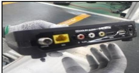
**Figura 1:** Parte posterior do Modem mostrando os conectores
