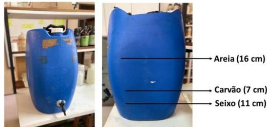
**Figura 1: Filtro de sedimentação (agroecológico) para limpeza de água contaminada.**
