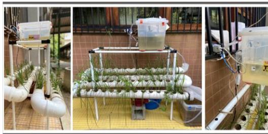
**Figura 5: SWC controlado com Arduino utilizando a espécie *Cyperus surinamensis*.**
